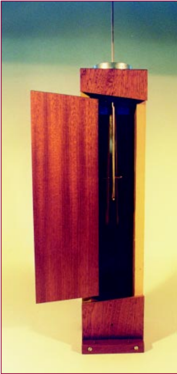
Holzstiefel von Bombarde 32' mit Schiebetürchen für besseren Zugang.
